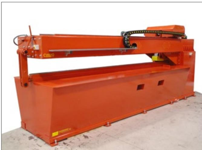
**Pressa per raddrizzare pannelli** saldati di lunghezza massima pari a 3200 mm e spessore massimo 6 mm. Il carrello si muove a velocità variabile ed il rullo pressore esercita una spinta di 4 ton su una incudine temprata. L'apertura/chiusura del gancio anteriore ad azionamento manuale con dispositivo di arresto automatico di ogni attività nel caso di chiusura imperfetta. L'allineamento è traggurato da linea Laser.
