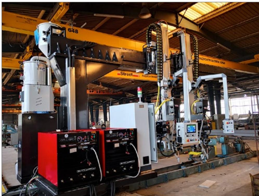
Manipolatore per la saldatura longitudinale di travi, con base motorizzata, montante in carpenteria, braccio fisso ad altezza fissa, due carrelli motorizzati e due bracci tuffanti corsa 1500mm.
