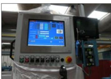
Pulpito di comando con schermo touch da 10", monitor 21" per la telecamera e pannello generatore MIG
