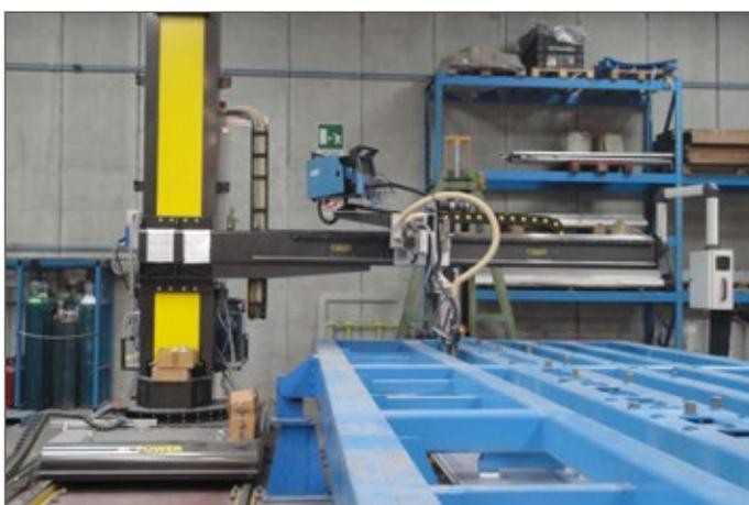
Macchina simile alla precedente, ma con torcia rotante, per permettere di eseguire in automatico saldature longitudinali o trasversali.
