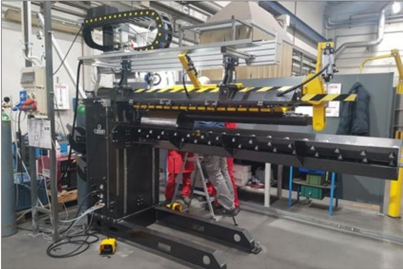
**Banco BP** con culla di supporto regolabile in altezza manualmente. La stessa può essere fornita anche con regolazione motorizzata.
