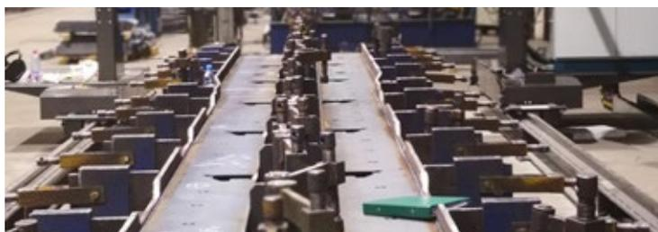
Ognuna delle quattro teste di saldatura è dotata di doppio seguigiunto tattile con puntale a sfera. Per ogni testa, una sonda seguigiunto pilota una slitta modello MMMIDI in senso verticale, mentre l'altra sonda pilota in senso orizzontale uno dei carrelli che scorrono sulla trave in alluminio.
