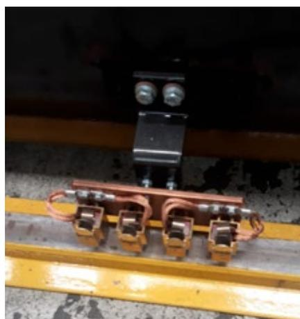
Nella fotografia qui in alto il particolare sistema di conduzione della massa: per evitare di installare lunghi cavi di massa lungo le rotaie, sfruttiamo le stesse per collegare la dima al generatore, interponendo carboni a strisciamento sulle rotaie.
