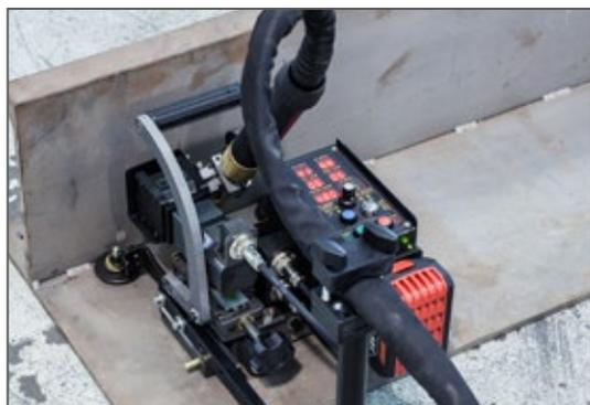
**Per saldature in angolo interno, con ruote motrici sul piano**
