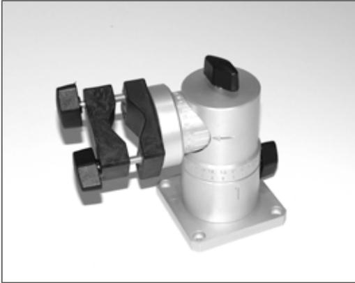
**TWIN** supporto torcia rotante su due assi ortogonali, con indicazione graduata, completo di porta torcia per  $\varnothing$  da 18 a 40 mm, freni di bloccaggio. Rotazioni complete di 360° su entrambi gli assi.
