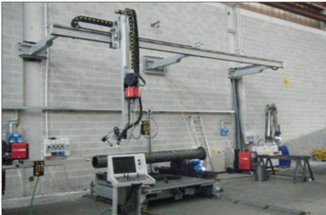
Trave MIDI con tuffante verticale con corsa utile 2 m. Sul tuffante è fissato il carrello traina-filo e una slitta orizzontale. Il tuffante e la slitta trasversale sono guidati dal sistema seguigiunto. Una telecamera permette il controllo a distanza del processo.
