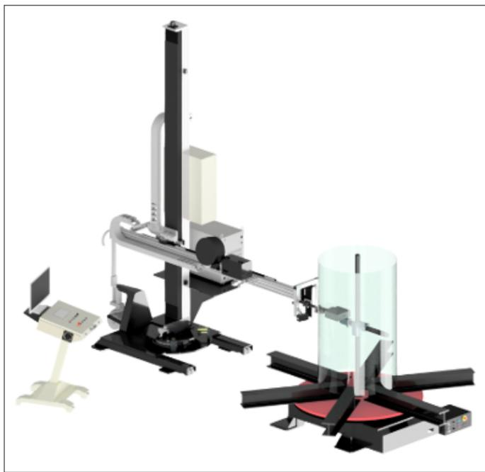
Tavola rotante Joda Plano50 con manipolatore AI Power MINI 2.5x2 a base fissa con transpallet. Sul braccio è installato il traino filo freddo VPR4WD, la telecamera ARCV, il guidafilo CEFF e la scarpetta per il gas SCPWT27. L'AVC è integrato nel braccio del manipolatore per compensare l'ellitticità della virola. Sulla tavola rotante è installato un supporto per il gas al rovescio per la protezione del bagno di saldatura.
