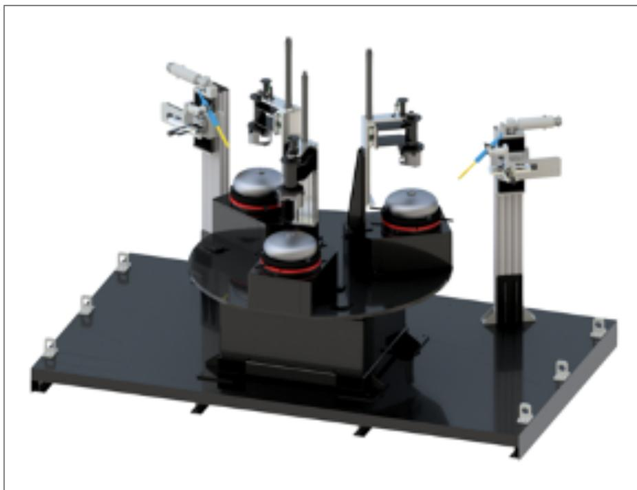
Sulla stazione in alto si effettua la saldatura MIG/MAG della ghiera e della maniglia al fondello superiore e successivamente del piede al fondello inferiore. Mentre l'operatore carica/scarica il pezzo sulla postazione anteriore, sulle due postazioni retrostanti avvengono le saldature in tempo mascherato.
