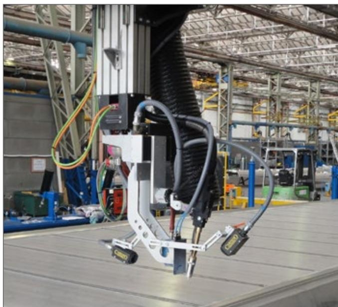
Polso a due assi: permette di ruotare la torcia a 0° e 180°, per fare la saldatura nei due sensi, ed inoltre il posizionamento a 45° sull'altro asse per fare le longitudinali ad angolo; tale riposizionamento automatico evita il ritorno a vuoto e il settaggio manuale della posizione della torcia.
