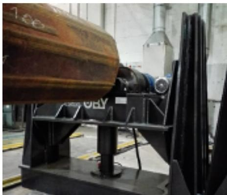
L'impianto è costituito da un manipolatore a braccio fisso modello ZP su carro motorizzato. Sul braccio scorrono due carrelli motorizzati sui quali sono installate le teste di saldatura.
