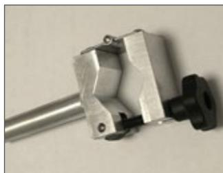
**CEBTCN** porta torcia a cerniera per un rapido bloccaggio della torcia, adatto a torce automatiche  $\varnothing 35-42$  mm.
