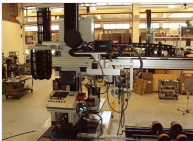
Il pulpito di comando è fissato sulla base del manipolatore. Da qui l'operatore, grazie alla telecamera potrà seguire il processo senza l'utilizzo di trabattelli o scale.
