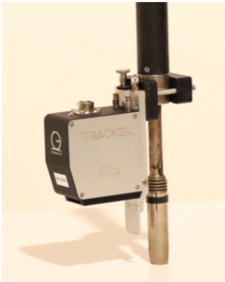
**TRACKER:** questo sensore utilizza il principio della triangolazione per eseguire continue scansioni del giunto. Rispetto al sistema tattile permette di seguire giunti con profondità molto ridotte, sino a 0,5 mm.
