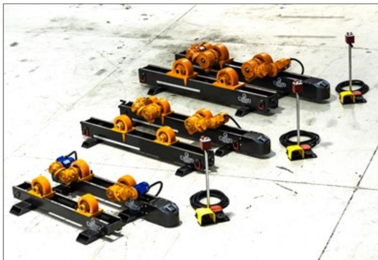
**OBY 3, 8 e 15** sono posizionatori a rulli bi-motori, con portate rispettivamente da 3, 8 e 15 Ton/coppia. Ogni traversa è costituita da una robusta trave in ferri a U saldati, lavorati di macchina utensile e verniciati. La lavorazione dei piani di scorrimento è sia planare che sull'allineamento delle ruote.
