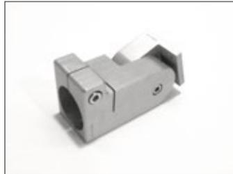
**B150001+2** Snodo a 2 assi, con morsetto per tubo  $\varnothing$ 60, flangia per fissaggio a slitte MM MINI, portata max 10 kg.
