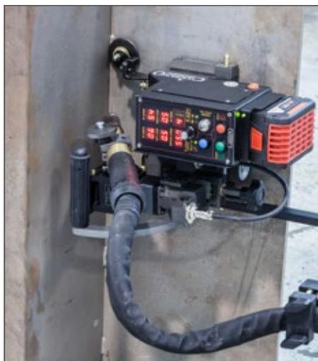
**Per saldare in verticale i magneti e il motore con encoder permettono un avanzamento preciso**
