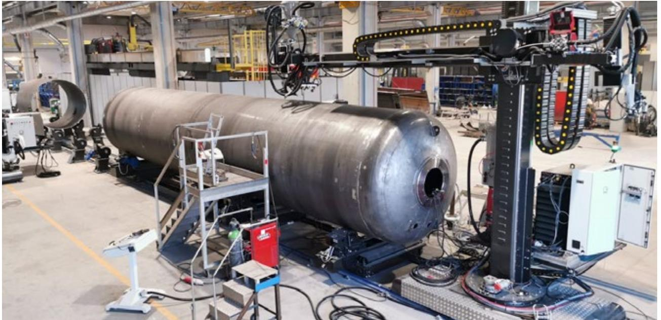
**Impianto per la realizzazione di serbatoi in pressione per autorimorchi costituito da manipolatori ZX con ralla motorizzata per la rotazione della colonna.**
