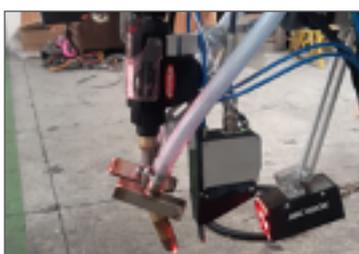
Testa di saldatura con telecamere ARCV e seguigiunto TRACKER
