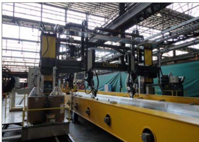
La traversa ad altezza variabile permette il passaggio sopra le strutture dei dispositivi di ribaltamento delle dime, per poi ridiscendere quando è posizionato sopra il manufatto.
