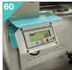
60 Visualizzazione angolo di taglio tramite display lcd. Angle digital display.
