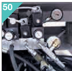
50 Due riduttori di pressione per morse idrauliche. Two pressure reducers for hydraulic vices.
