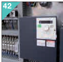
42 Variatore di velocità lama. Inverter for variable blade speed.
