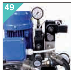
49 Un riduttore di pressione per morsa idraulica. One pressure reducer for hydraulic vice.
