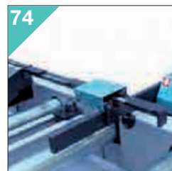
74 RL RTR Riscontro di misura digitale con rallentamento automatico. Digital reading length stop with automatic slow down sensors.
