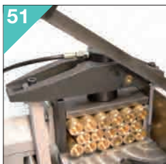
51 Dispositivo oleodinamico per taglio a fascio. Hydraulic device for bundle cutting.
