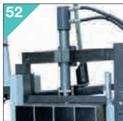
52 Dispositivo oleodinamico per taglio a fascio. Hydraulic device for bundle cutting.
