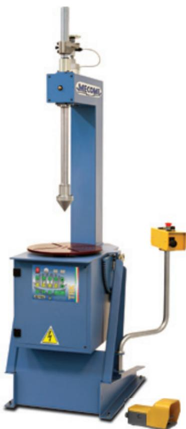
Gli impianti TRK sono posizionatori da banco o a colonna per la saldatura circolare manuale o automatica con portate da 35 a 150 Kg. Tutti i modelli possono essere inclinati da 0° a 90° con posizionamento ogni 10° e velocità di rotazione variabile tramite potenziometro.
