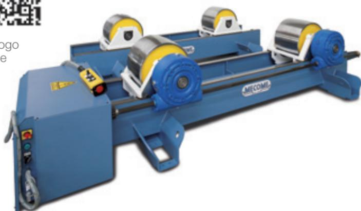
La gamma dei posizionatori a rulli PR (standard) e PRB (ad auto centraggio) copre una vasta gamma di applicazioni con portate da 1,5 a 100 tonnellate con lo scopo di movimentare serbatoi, tubi cilindrici e metallici di piccole, medie e grandi dimensioni. Sono utilizzati nelle operazioni di verniciatura, di taglio, di assemblaggio, di saldatura e in connessione con manipolatori, travi e portali.
