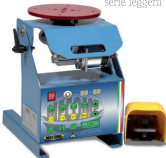
Gli impianti PL sono posizionatori da banco o a colonna per la saldatura circolare manuale o automatica con portate da 30 a 180 Kg. Tutti i modelli possono essere inclinati da 0° a 90° con posizionamento ogni 10° e velocità di rotazione variabile tramite potenziometro.
