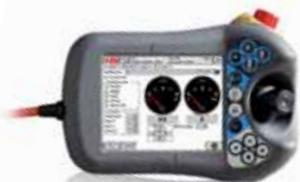
L'interfaccia operatore che permette la programmazione dell'intero processo di saldatura, ha un funzionamento intuitivo essendo costituita da uno schermo touch screen, solo otto tasti per operazioni preimpostate e joystick per facilitare la programmazione per autoapprendimento. È l'unità di governo che consente la programmazione di stazioni dove operano fino a 36 assi (quattro robot + 12 assi esterni)
