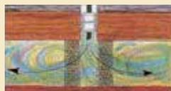
Il "packer", esercitando una forte tenuta sulla parete del pozzo, permette l'immissione di anidride carbonica, in fase liquida e gassosa, nel pozzo e nelle formazioni geologiche circostanti.
